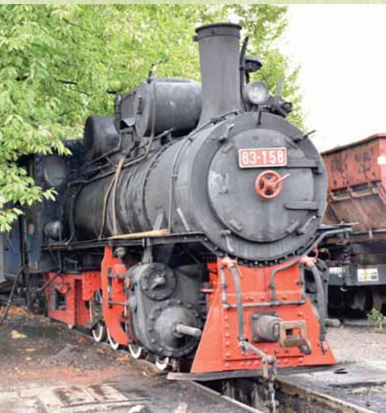
Proteklih nekoliko mjeseci na pogonu „Željeznički transport“ rađeno je na obnovi parne lokomotive 83-158 proizvedene 1948. godine za čiju sanaciju više nije moguće pronaći odgovarajuće rezervne dijelove, te se moralo pristupiti improvizaciji i reparaciji starih dijelova.
